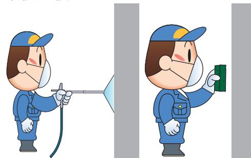
足場がない為、洗浄剤 A 1 塗布し、低圧で洗浄、ペーパーサンディングでコンクリートの美観は新築時に
