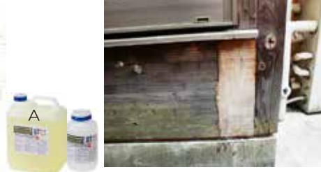
重度の木部のカビへの洗浄力の確認 A4:B1 混合液を 2 倍希釈で塗布
