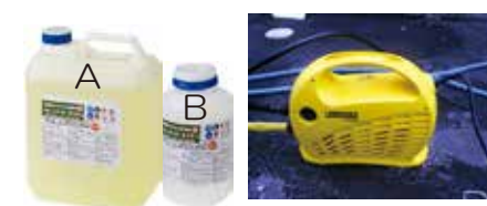
重度の木部のカビへの洗浄力の確認 A4:B1 混合液を 2 倍希釈で塗布
