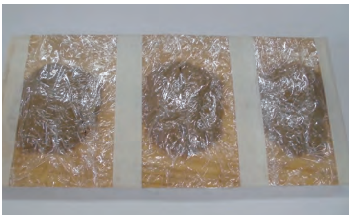
貼り付けた混合粘土にラップする
