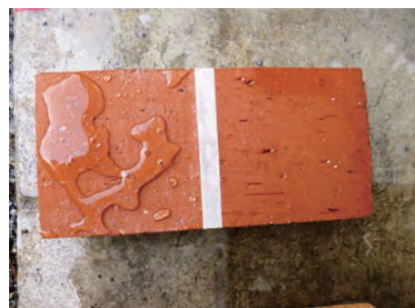
レンガ内部にシリコン防水層
