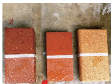
レンガ内部にシリコン防水層
