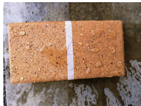
レンガ内部にシリコン防水層
