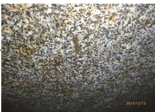
水性防水剤 Water Proofを塗布 面は防水状態で水滴で水滴が垂れます
