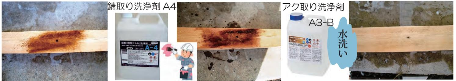
木の錆に A4 を塗布すると錆は水溶化し紫色に変わります。次に A3-B を塗布すると透明になり、水洗いで終了。
