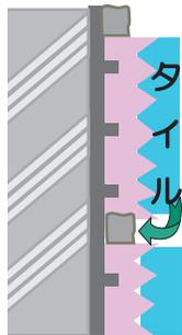
洗浄で荒れたタイル表面は無機質のガラスで平滑に補修され、タイル表面から流れ落ちた釉薬と同じ成分のガラスが目地に流れ込みます
