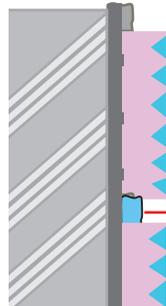
荒れたタイルの表面に膜を作らず、ガラスで平滑に補修し、表面は硬度8Hに修復されて撥水します。目地にはガラスの汲水防止層
