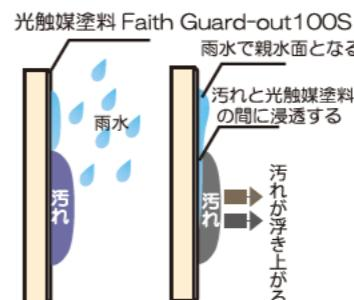
汚れと光触媒塗料の間に浸透する
