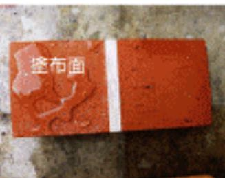
砂岩石への防水力を確認 塗布面には白華は起りません レンガへの水の浸透と白華や凍結融解のひび割れ
